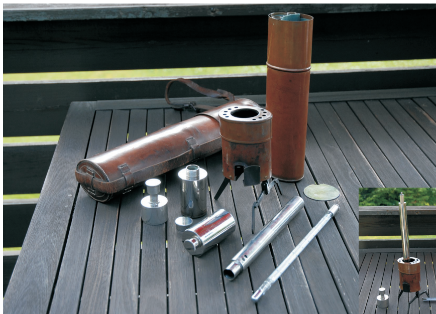
På listen over videnskabeligt måleudstyr, som blev doneret af 'Carlsbergfondet', var et såkaldt hypsometer. Ved at måle vandets kogepunkt kunne man foretage højdemålinger af terrænet. Instrumentet er bevaret for eftertiden i privat eje. På det store billede ses hypsometrets enkeltdele, det lille billede viser det samlede instrument. Foto: Jan Koed
